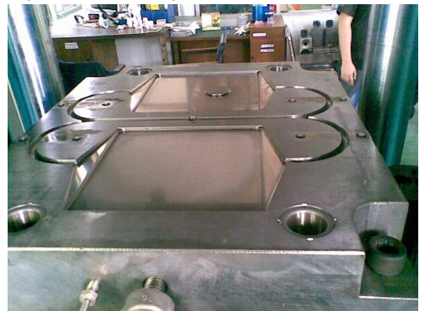
รูปที่ 1 แม่พิมพ์สำหรับฉีดขึ้นรูป
