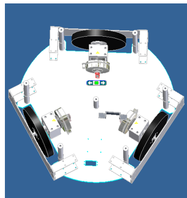
รูปที่ 15 ลักษณะการวางล้อในหุ่นยนต์รุ่นที่สอง
