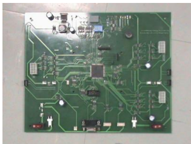
รูปที่ 6 แผงวงจรหลักที่ใช้ในค้วหุ่นยนต์
