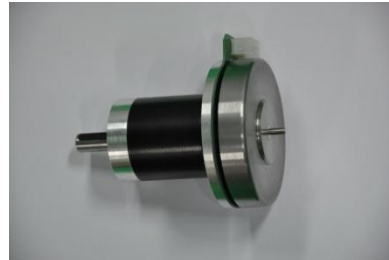
รูปที่ 2 มอเตอร์ไร้แปรงถ่านแม่เหล็กขั้ว 90
