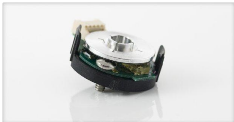
รูปที่ 5 เอนโคเดอร์ที่ใช้ในโครงการ รุ่น E4P-360 ของ USdigital
