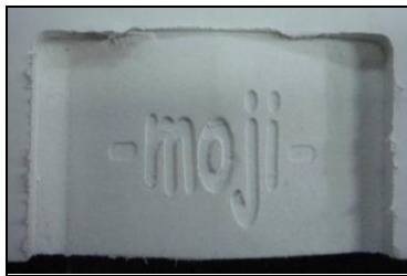
ภาพที่ 6 ชิ้นงานที่ทดลองกัดโดย CNC Engraving Machine
