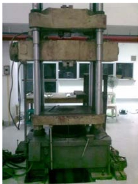
ภาพที่ 13 การทดสอบการรับน้ำหนักแบกทานของกระสอบ
