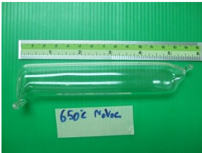
รูปที่ 1 แคปซูลบรรยากาศปกติที่ผ่านการเผา
