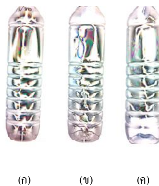
รูปที่ 5 เปรียบเทียบความเค้นตกค้างที่เกิดขึ้นภายในชิ้นงานของหลอดพรีฟอร์มขนาด (ก) 17 g (ข) 20 g และ (ค) 34 g
