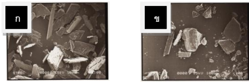
รูปที่ 4.5 ยาหลังกระบวนการภายใต้สภาวะอุณหภูมิ 45 °C ในตัวทำละลาย ก)เอทานอล ข) อะซิโตน
