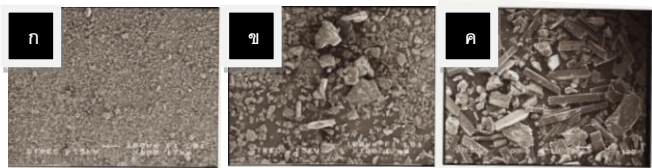
รูปที่ 4.6 ภาพถ่ายจาก SEM ด้วยกำลังขยาย 100 เท่าของ ก) ยาที่ผ่านการลดขนาดจากตัวแทนจำหน่าย ข) ยาก่อนกระบวนการ (Sigma) และ ค) ยาหลังกระบวนการ GAS
