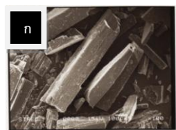
รูปที่ 4.2 ยาหลังกระบวนการ ภายใต้สภาวะ 35 °C ในตัวทำละลายอะซิโตน ก) ความเข้มข้น 25 เปอร์เซ็นต์ ข) ความเข้มข้น 75 เปอร์เซ็นต์
