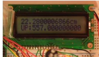
ภาพที่ 1 ระยะทางที่ 22 เซนติเมตร และเวลาจากตัวส่ง (Up Steam) ไปตัวรับ (Down Steam)
