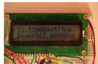
ภาพที่ 1 ระยะทางที่ 22 เซนติเมตร และเวลาจากตัวส่ง (Up Steam) ไปตัวรับ (Down Steam)
